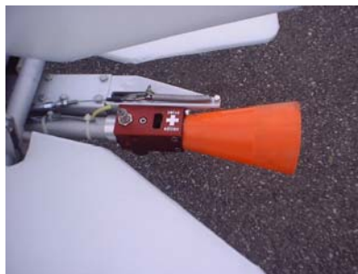
Bild 1 und 2: Automatische Schleppeinzugswinde im Ikarus C42B: Der linke Teil bleibt sehr ähnlich, der Seilträger wird verändert um eine einfache Demontage des Seiles zu ermöglichen.
