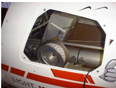
Bild 1 und 2: Automatische Schleppeinzugswinde im Ikarus C42B: Der linke Teil bleibt sehr ähnlich, der Seilträger wird verändert um eine einfache Demontage des Seiles zu ermöglichen.
